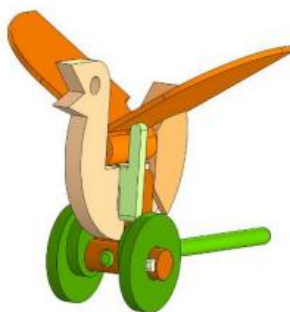
Рис.2 – Модель игрушки «Птица» с кулачковым механизмом
