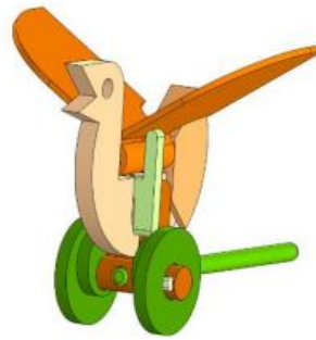
Рис.2 – Модель игрушки «Птица» с кулачковым механизмом
