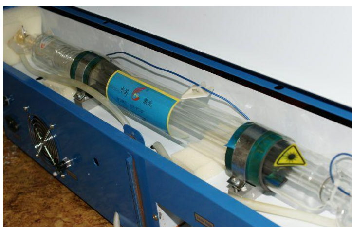
Рис.2 Трубка лазерно-гравировальной машины, генерирующая CO2.
