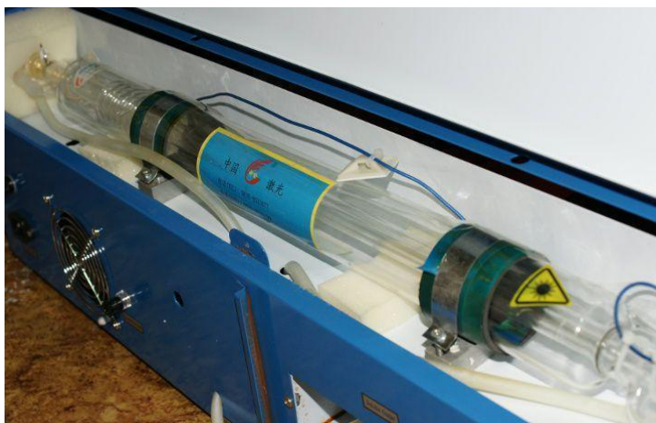
Рис.2 Трубка лазерно-гравировальной машины, генерирующая CO2.
