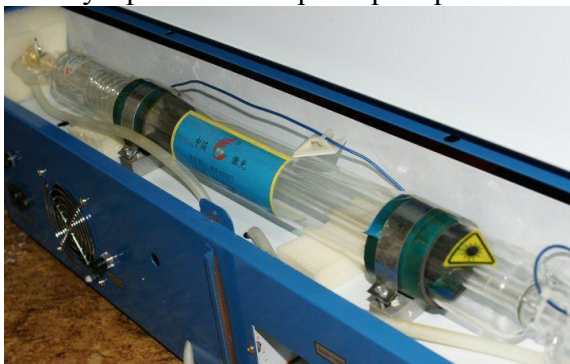
Рис.2 Трубка лазерно-гравировальной машины, генерирующая CO2.
