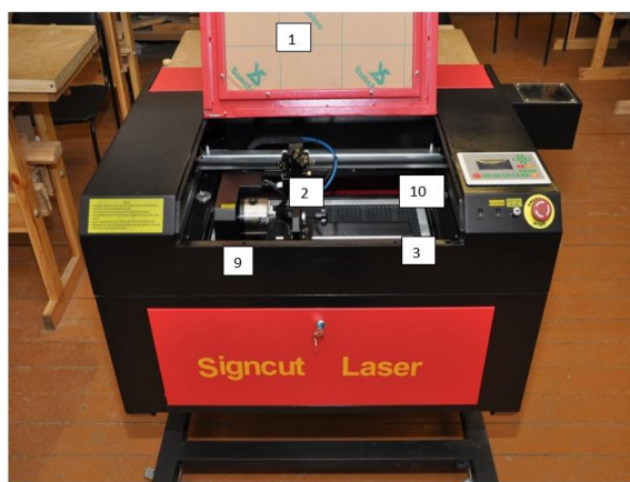
Рис. 4 Устройство лазерно-гравировального станка (а и б)
