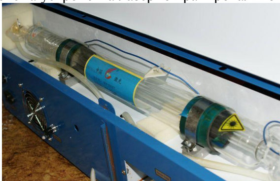
Рис.2 Трубка лазерно-гравировальной машины, генерирующая CO2.
