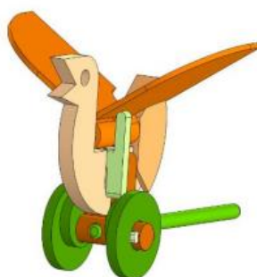
Рис.2 – Модель игрушки «Птица» с кулачковым механизмом
