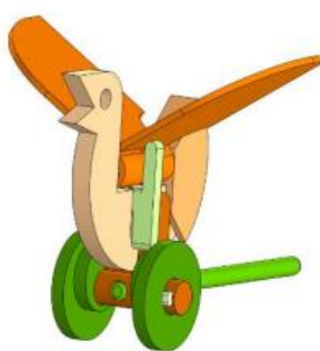
Рис.2 – Модель игрушки «Птица» с кулачковым механизмом
