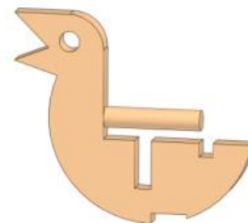
Рис.3 – Вариант детали «туловище» с осью
