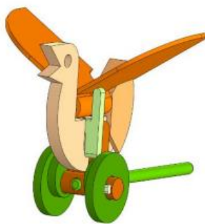
Рис.2 – Модель игрушки «Птица» с кулачковым механизмом
