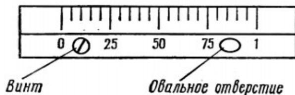
Рис. 12 - Перемещение линейки нониуса
