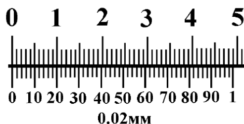
Рис. 1- Измерительная шкала нониуса (нулевое положение)
