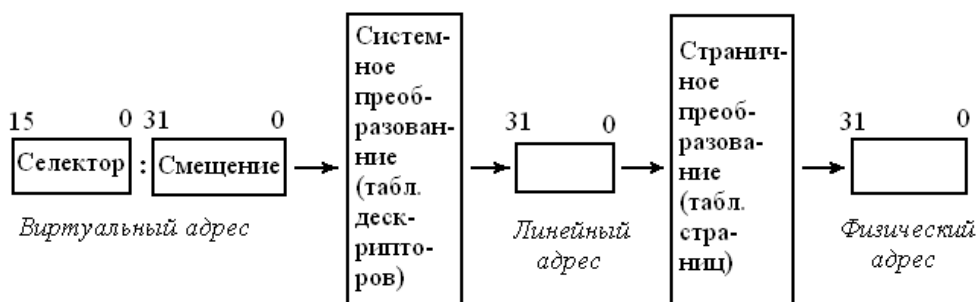
Рис.7. Схема преобразования виртуального адреса в физический [16]
