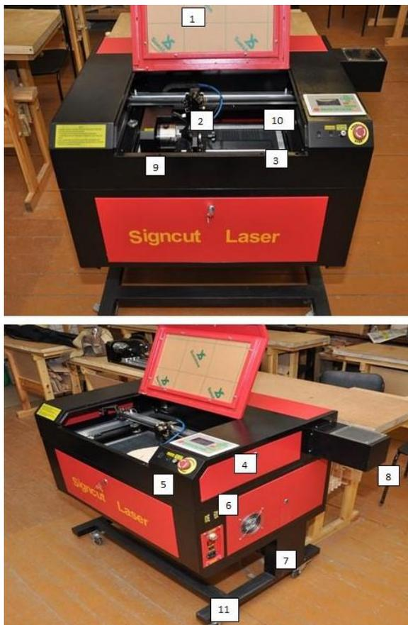
Рис.4 Устройство лазерно-гравировального станка (а и б)
