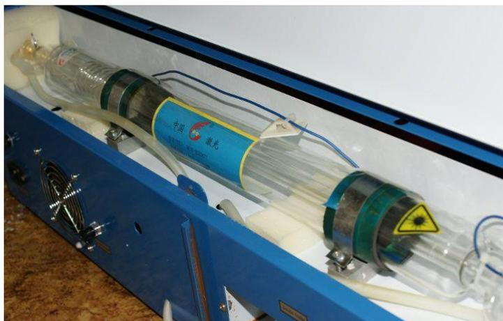
Рис.2 Трубка лазерно-гравировальной машины, генерирующая CO2.
