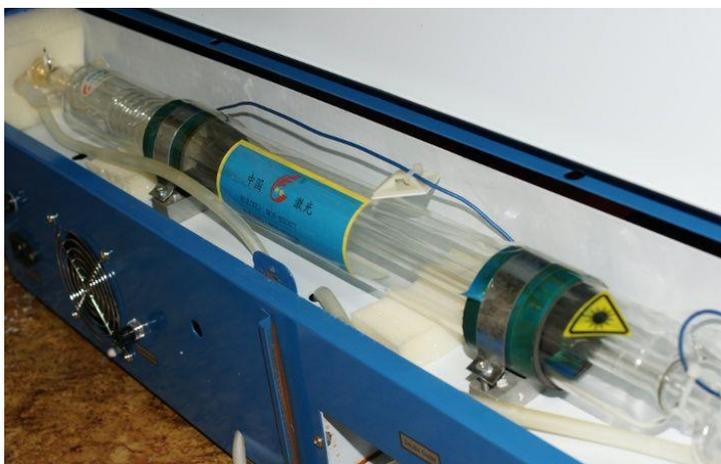
Рис.2 Трубка лазерно-гравировальной машины, генерирующая CO2.
