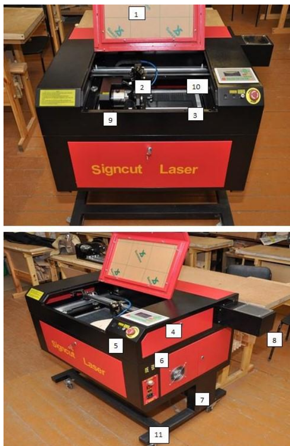
Рис.4 Устройство лазерно-гравировального станка (а и б)
