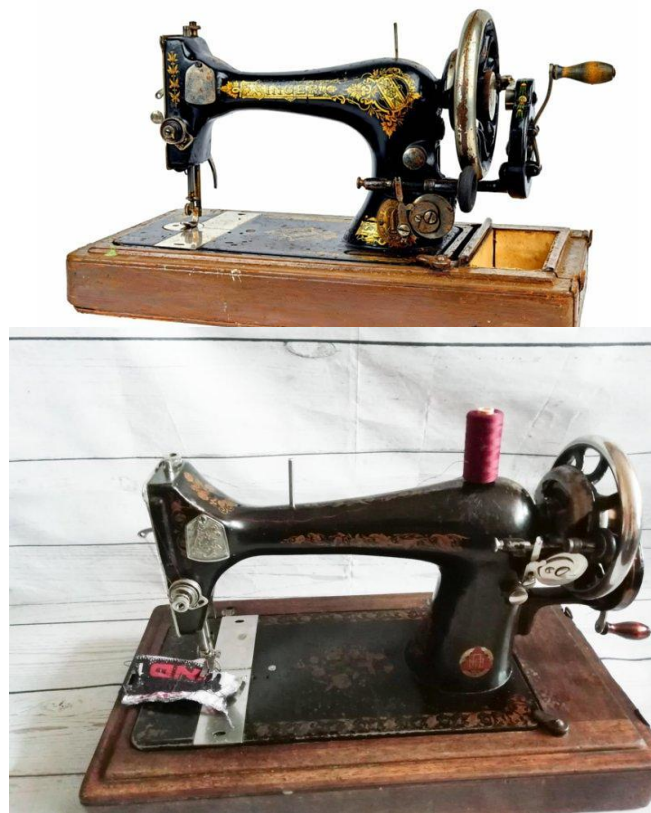
(Рис. 1) Пример ручной прямошвейной машины
