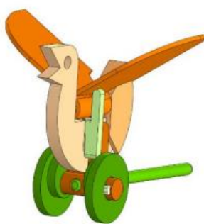
Рис.2 – Модель игрушки «Птица» с кулачковым механизмом
