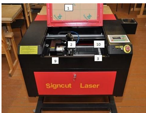
Рис.3 Проход видимого лазерного пучка по зеркалам лазерно-гравировальной машины
