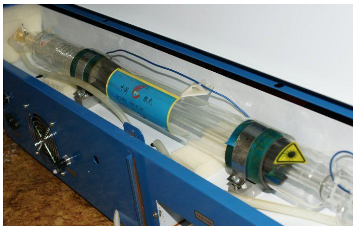
Рис.2 Трубка лазерно-гравировальной машины, генерирующая CO2.
