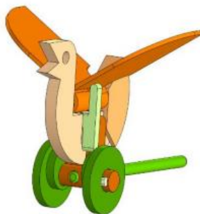
Рис.2 – Модель игрушки «Птица» с кулачковым механизмом
