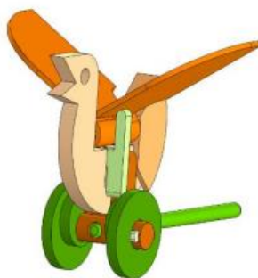
Рис.2 – Модель игрушки «Птица» с кулачковым механизмом
