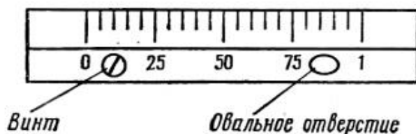
Рис. 12 - Перемещение линейки нониуса
