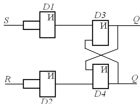
Рис.6. Логическая схема триггера [15]
