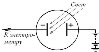
Рис.2. Принципиальная схема установки для исследования фотоэффекта [12]
