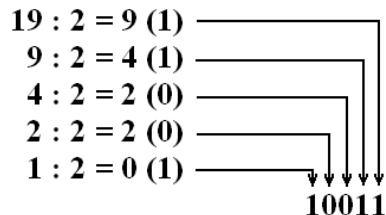
Рис.4. Схема алгоритма перевода десятичного числа в двоичное [13]
