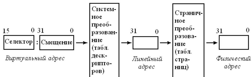
Рис.7. Схема преобразования виртуального адреса в физический [16]
