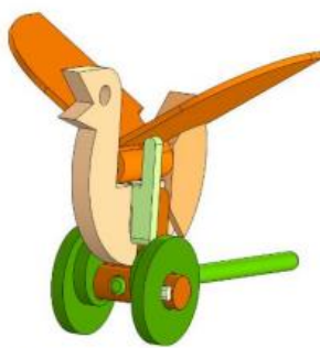
Рис.2 – Модель игрушки «Птица» с кулачковым механизмом
