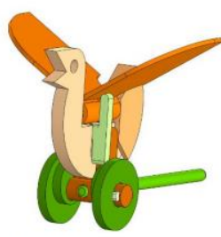
Рис.2 – Модель игрушки «Птица» с кулачковым механизмом
