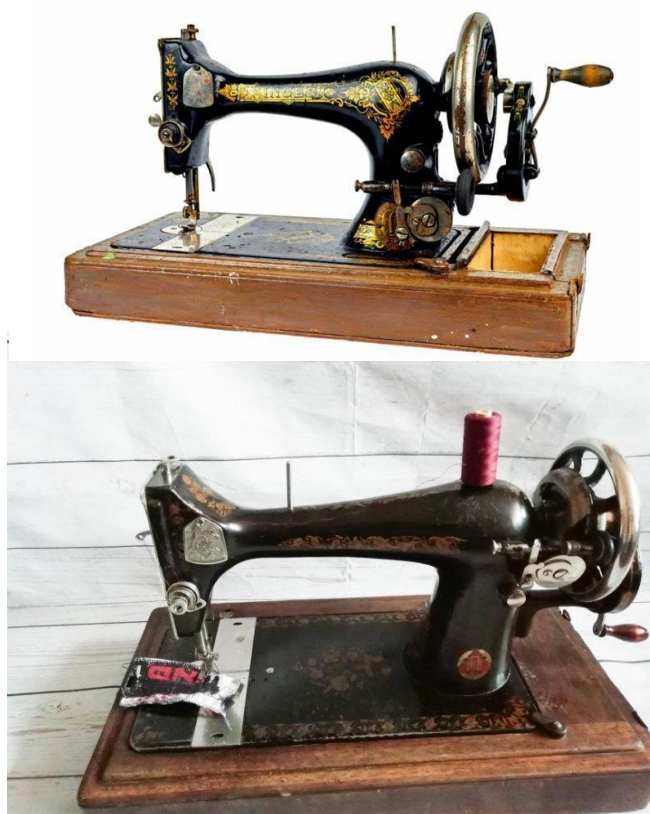
(Рис. 1) Пример ручной прямострочной швейной машины
