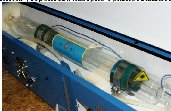
Рис.2 Трубка лазерно-гравировальной машины, генерирующая CO2.
