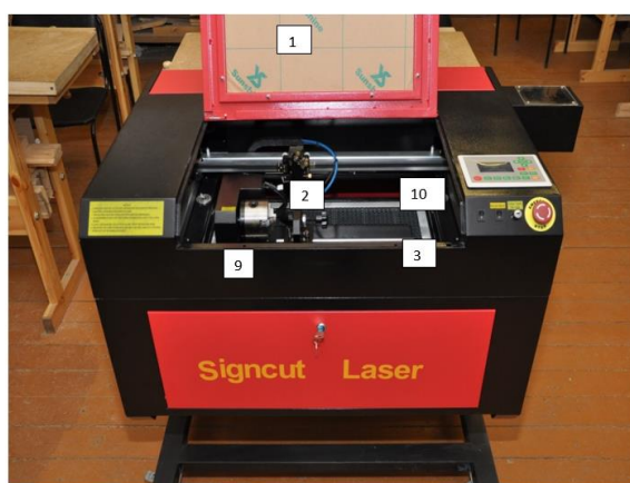
Рис. 4 Устройство лазерно-гравировального станка (а и б)
