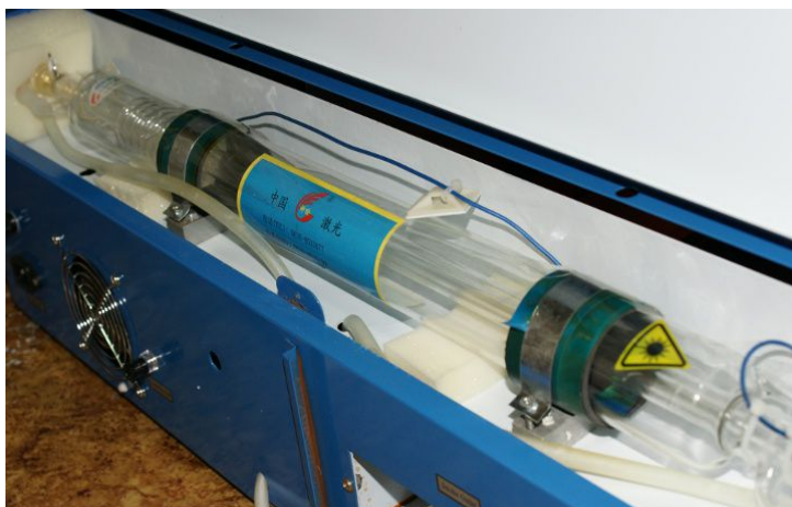
Рис.2 Трубка лазерно-гравировальной машины, генерирующая CO2.
