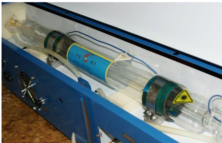
Рис.2 Трубка лазерно-гравировальной машины, генерирующая CO2.
