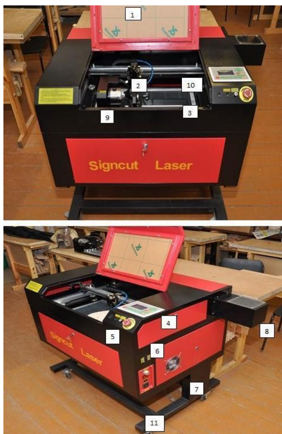
Рис.4 Устройство лазерно-гравировального станка (а и б)
