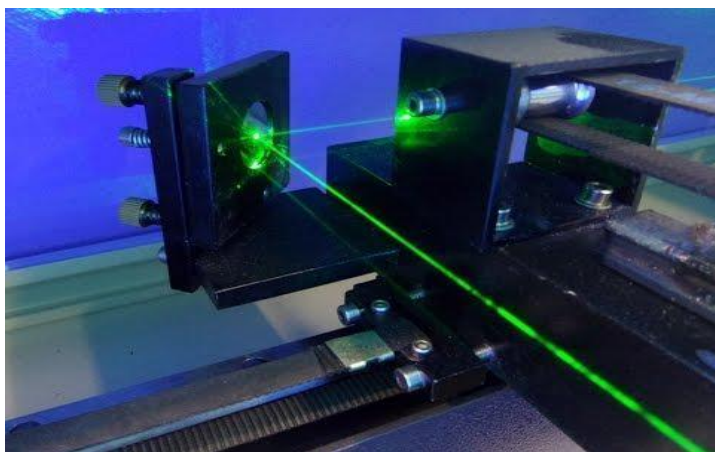
Рис.3 Проход видимого лазерного пучка по зеркалам лазерно-гравировальной машины
