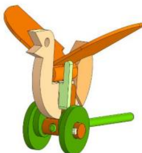
Рис.2 – Модель игрушки «Птица» с кулачковым механизмом
