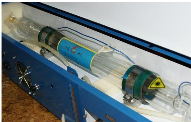
Рис.2 Трубка лазерно-гравировальной машины, генерирующая CO2.
