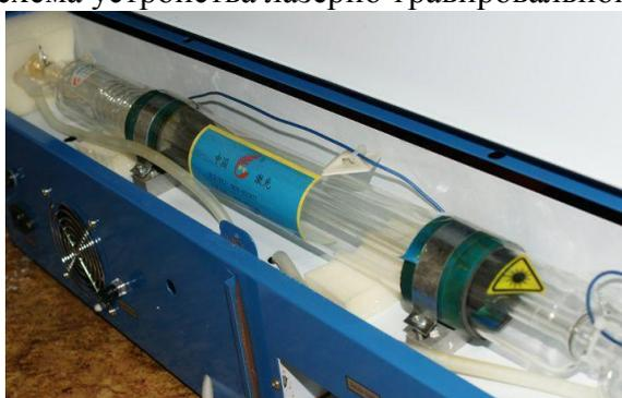
Рис.2 Трубка лазерно-гравировальной машины, генерирующая CO2.
