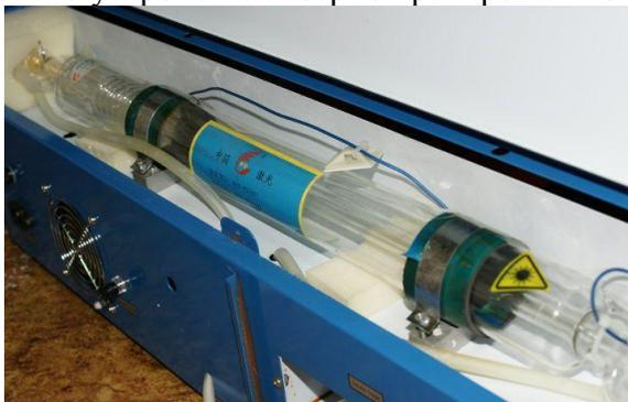
Рис.2 Трубка лазерно-гравировальной машины, генерирующая CO2.
