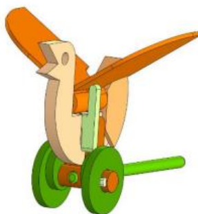
Рис.2 – Модель игрушки «Птица» с кулачковым механизмом
