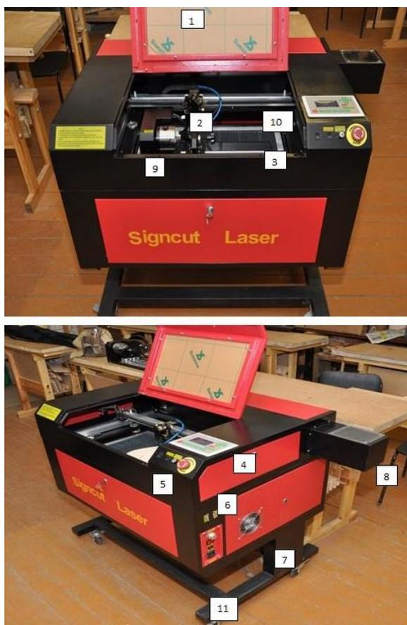
Рис.4 Устройство лазерно-гравировального станка (а и б)
