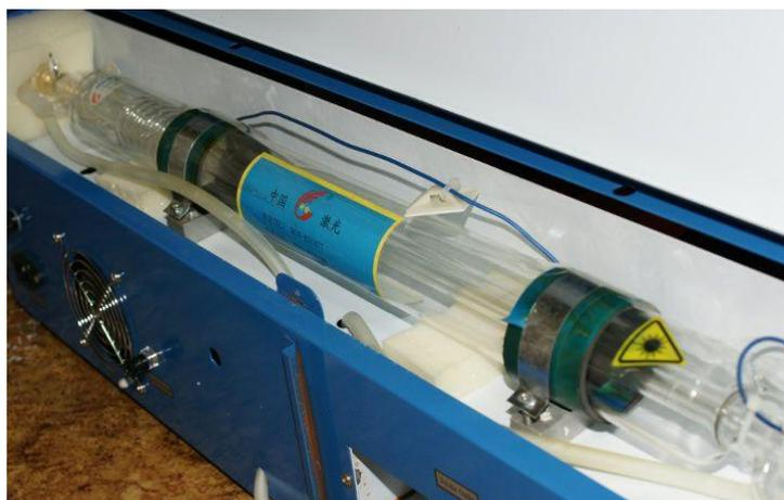
Рис.2 Трубка лазерно-гравировальной машины, генерирующая CO2.
