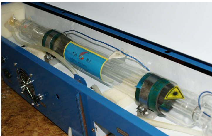
Рис.2 Трубка лазерно-гравировальной машины, генерирующая CO2.
