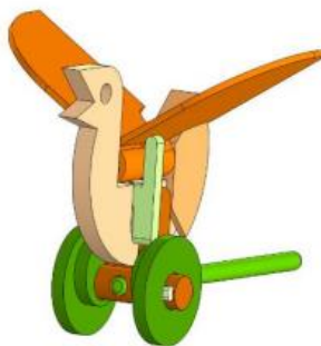
Рис.2 – Модель игрушки «Птица» с кулачковым механизмом
