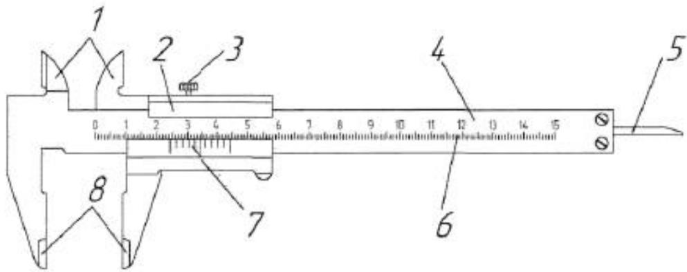
Рис. 3 - Штангенциркуль ШЦ I двухсторонний с глубиномером
