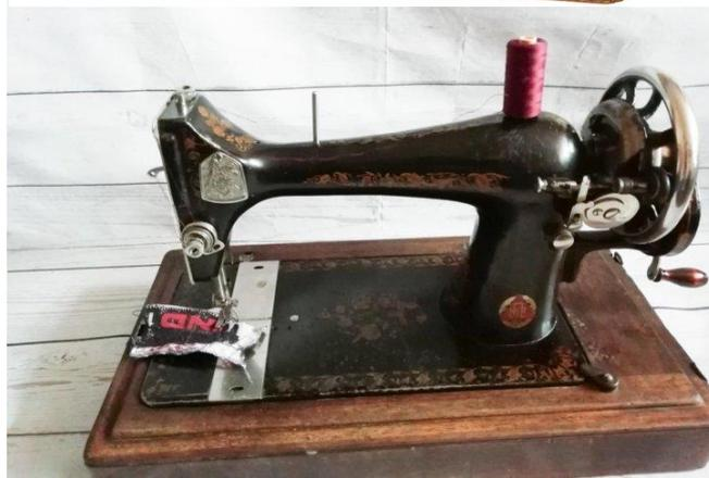
(Рис. 1) Пример ручной прямострочной швейной машины
