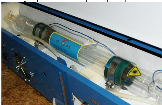
Рис.2 Трубка лазерно-гравировальной машины, генерирующая CO2.
