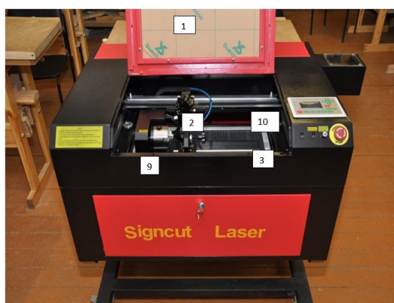
Рис. 4 Устройство лазерно-гравировального станка (а и б)
